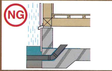
基礎外周の地盤面高さを基礎耐圧盤天端よりも上げないようにしましょう。上げてしまうと雨などの浸水の原因となります。
